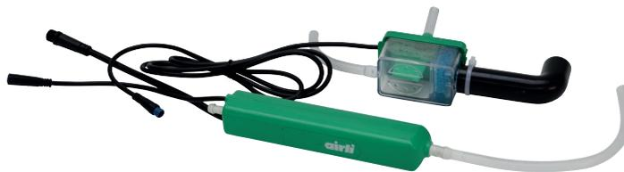
Die Airli A-20 Kondenswasserpumpe verwendet einen kapazitiven Sensor zur Wassererkennung anstelle dem traditionellen Schwimmer-Element. Die automatische Durchflussanpassung reduziert die Funktionsgeräusche erheblich und verlängert die Lebensdauer der Pumpe und der elektronischen Komponenten.
